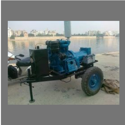
15 KVA Trolley DG Set
