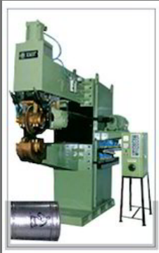
Pneumatic Longitudinal Seam Welder
