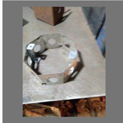
Electrical Fan Box
