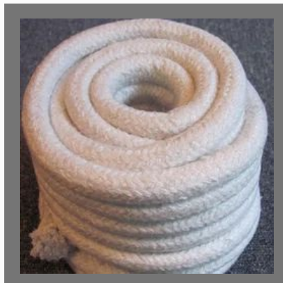
Asbestos Rope Lagging
