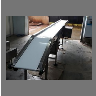
PU Belt Conveyor
