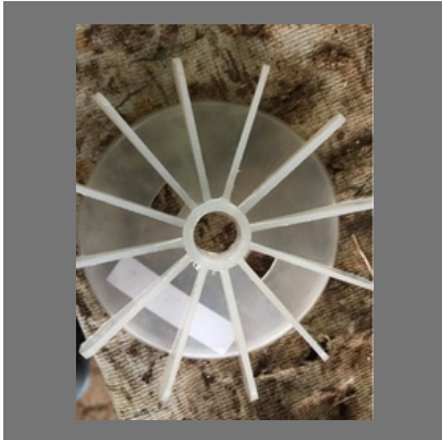
Motor Cooling Fan
