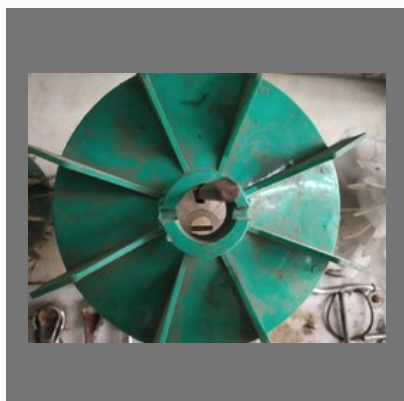
Pump Cooling Fan
