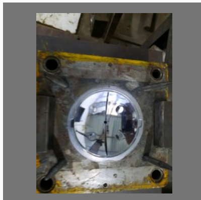
Jar Cap Mould
