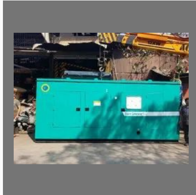
380 kva Diesel Generator
