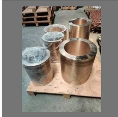
Non Ferrous Centrifugal Casting
