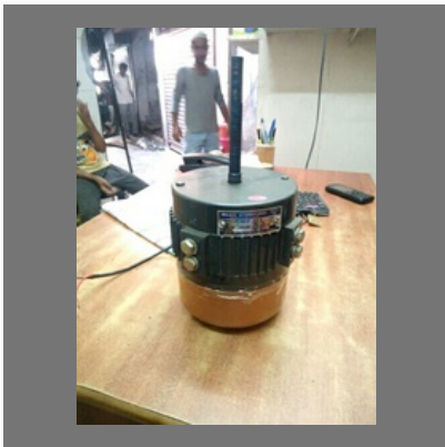
Cooler Fan Motor
