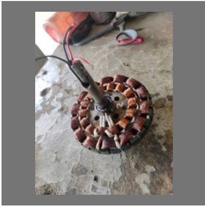
Celling Fan Rewinding
