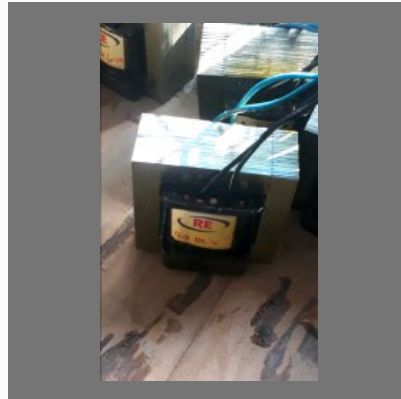
Electric Transformer input volt 440 output volt 18
