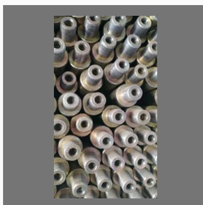
Ceiling Fan Shaft
