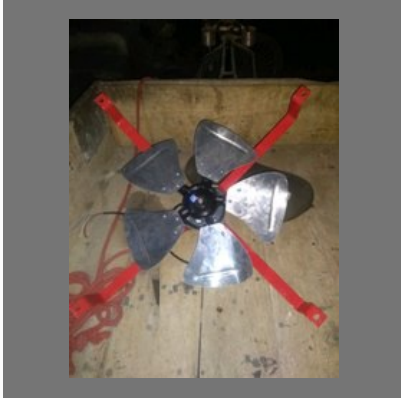
Cooler Fan Blades
