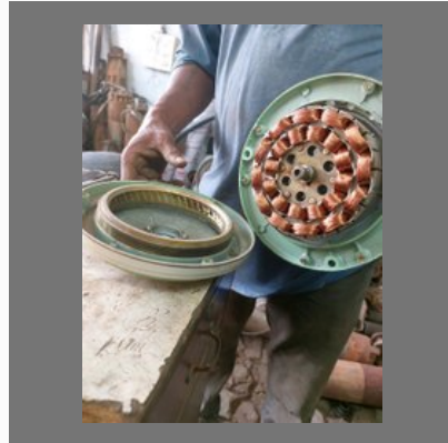
Fan Motor Rewinding
