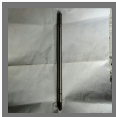
Wall Fan Shaft
